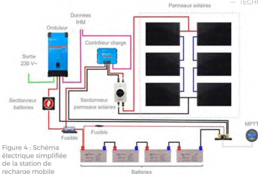
Figure 4 : Schéma électrique simplifié de la station de recharge mobile
