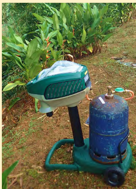
Figure 4 : Photo d'un Mosquito Magnet déployé sur le terrain. [Crédit photo : Vectopôle, Institut Pasteur de la Guyane]. Le Mosquito Magnet est un piège permettant de capturer des moustiques adultes sur le terrain. La bombonne de gaz est utilisée par le dispositif pour émettre du CO 2 et produire de la chaleur. Une pastille avec une molécule attractante est ajoutée et son odeur est également diffusée par le système. Ces stimuli attirent les femelles en quête de repas de sang et lorsque ces dernières s'approchent, elles sont aspirées par un flux d'air les piégeant dans le filet au cœur de la machine. Ce filet peut être fermé et retiré pour récupérer les moustiques.
